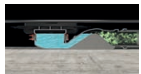
Siphon anti-odeur permanent grâce à la forme courbée
